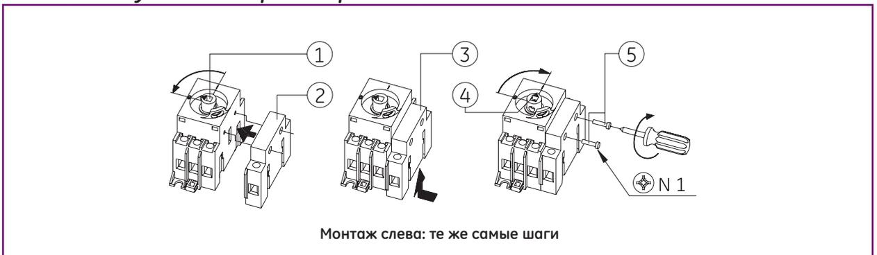
*Монтаж дополнительных полюсов и дополнительных контактов*
