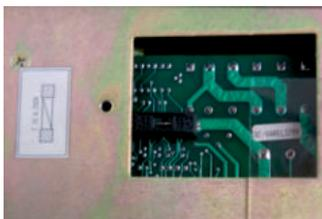
На одной из сторон корпуса находится пространство для предохранителей. В случае перегорания предохранителя светодиод, соответствующий предохранителю, подлежащему замене, загорится.
