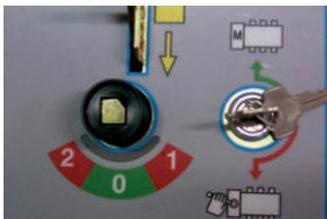
Поворот ключа в ручное положение, можно действовать вручную через рукоятку, в то же самое время электрическая работа запрещена. При ручном управлении на дисплее будут продолжать показываться различные положения переключения (I-0-II).
