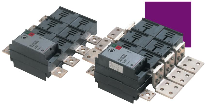
Подключения концов линий (1600–2500A) являются симметричными и могут быть повернуты на 180°, что позволяет обеспечить простую установку трансформаторов тока
